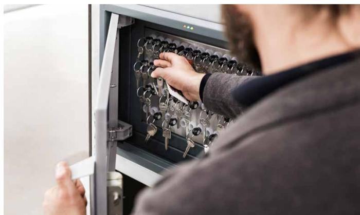
In diesem Schlüsselschrank sind die mechanischen Schlüssel der Werkstatt durch keyTags gesichert. Wer entsprechende Ressourcen gebucht hat, kann mit seiner persönlichen RFID-Karte den Schrank öffnen und die Schlüssel entnehmen, für die er eine Berechtigung hat. ■
